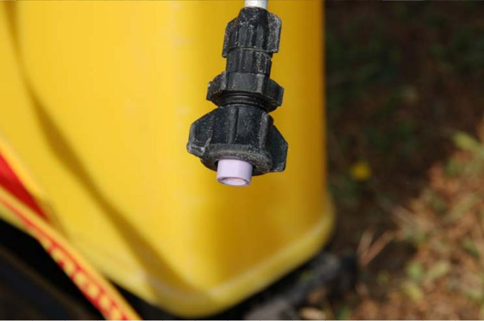
Buses à turbulence et grande vitesse d'accélération pour les thermiques
