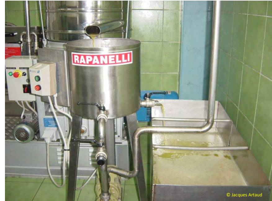
Récupération de l'huile après centrifugation
