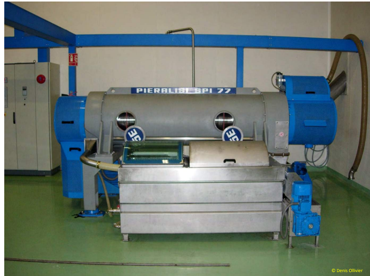
Décanteur horizontal continu
