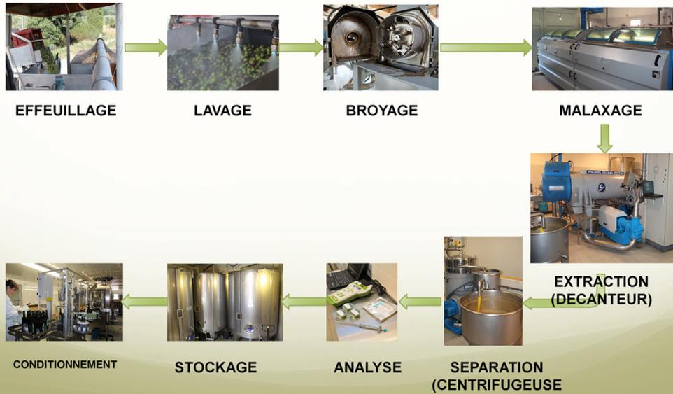
Dans ce cas on distingue les différents postes du process de fabrication de l'huile d'olive. Dans la configuration donnée ci dessus, on voit que les différents équipements sont « en série », qu'il n'y a aucune redondance d'équipement (La défaillance d'un équipement entraîne l'arrêt de la production).
