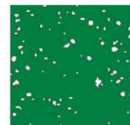
Pulvérisation trop clairsmée : à éviter
